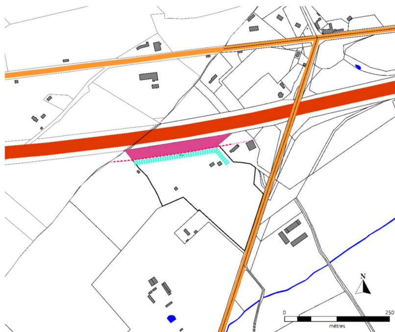
Projet après l'étude et présenté avec le secteur d'inconstructibilité réduit à 50 m de l'axe de l'autoroute.
