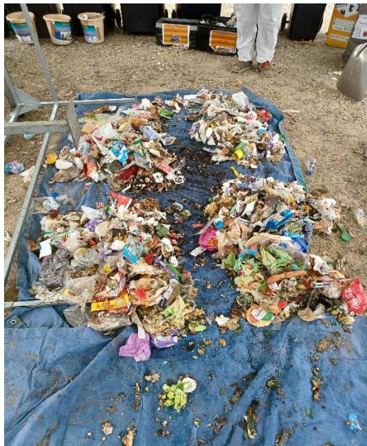
Récupération de la fraction 20-100 mm, puis réalisation du quartage
